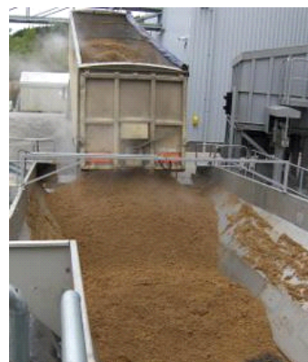
La centrale utilise un sous-produit résultant de la production du whisky - la drêche, provenant de 17 distilleries, mélangée à 50% avec des copeaux de bois.
