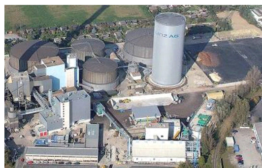
Le 18 % du chauffage urbain global pour la troisième plus grande ville d'Autriche, Linz, est assuré par une centrale de cogénération chaleur-électricité (CHP) à la biomasse.
